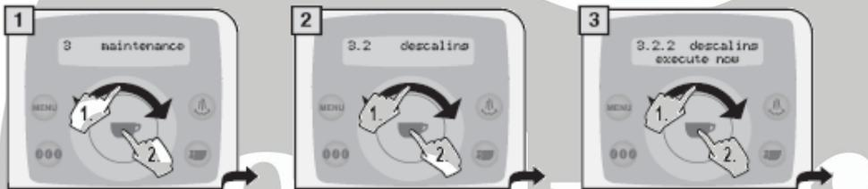
清洗鍋爐的過程機器必須在一定的溫度下進行，如果機器是冷的，就必須等到加熱完全才可進行，如果過熱，則必須像以下步驟冷卻鍋爐……
