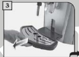
3 取出滴水盤並清洗乾淨不可放入洗碗機清洗
