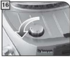
將蒸氣/熱水鈕之黑點（●）圖像轉至箭頭對齊，如果需要必須再檢查水箱的水量和重新更換濾水器
