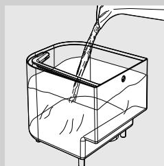
**4** 用乾淨的水沖洗並注滿，不可超過水箱內標示的最大 (MAX) 刻度。將水箱放回原位，重新蓋上蓋子。
