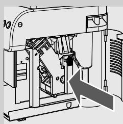
**10** 將沖煮系統再插回原來的盤座，直到鎖定到位，無需按「PRESS」
