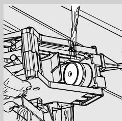
**4** 以溫水清洗沖煮系統，並仔細洗淨上濾水器。將沖煮系統放回機器上時，要確定已將沖煮壺中的水份瀝乾。
