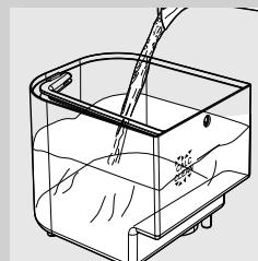
7 將整瓶 Saeco 濃縮除鈣劑倒入水箱中，然後加入乾淨的飲用水，直到 圖示指示的位置。
