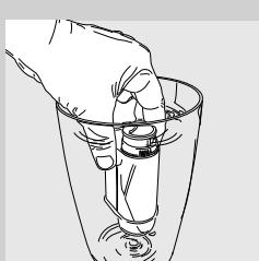
**3** 將「INTENZA+」濾水器垂直浸泡在冷水中（開口朝上），輕按兩側以排出氣泡。
