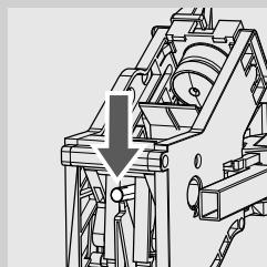
**3** 將沖煮系統再插回原來的盤座，直到鎖定到位，無需按「PRESS」（按）鈕。
