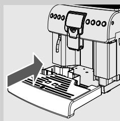
**1** 將附支架的滴水盤裝在機器上。確認滴水盤完全插到底。
