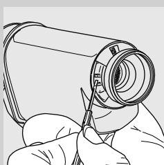
**2** 從包裝中取出「INTENZA+」濾水器。濾水器應按照水質硬度測得結果而設定。請使用機器所提供的水質硬度試紙。如濾水器包裝所示，設定「Intenza Aroma System」（請參閱「水質硬度測量與調整」章節）。
