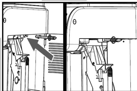
**警示：**使用斷電鑰匙解除安全微調是一個危險的動作，因此在調整後必須馬上移除。
