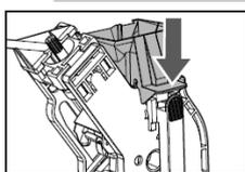
11、待上述9、10兩處沖泡組零件均檢查完整，可將其歸位，握住沖泡組，不可壓沖泡組《PREE》的位置，直接往內推即可。
