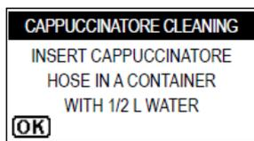
16、當液晶螢幕出現上圖訊息，將容器徹底清洗乾淨，之後將其裝滿 1/2 乾淨新鮮的水，將清洗管子插入其中，將為清洗之用。
