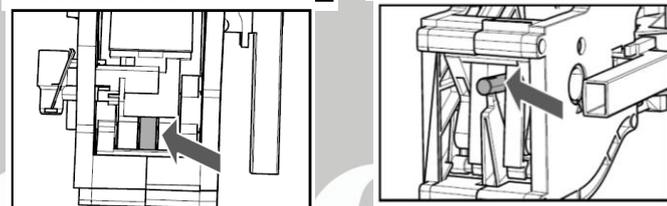
3、將沖泡組歸位，不可壓“PRESS”的位置，直接推回原處。
