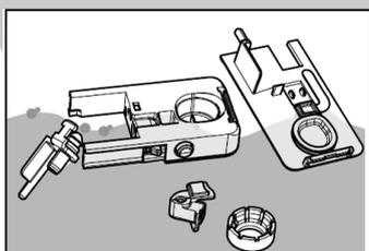
15、清洗乾淨之後，將零件依拆卸步驟反向組裝回去。
