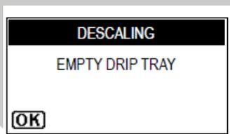
10、液晶螢幕出現上圖訊息時，將滴水盤取下傾倒乾淨，再歸位。如右圖：
