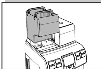
4、將水倒入水箱中，勿超過最大量(MAX)的容量，如下圖：
