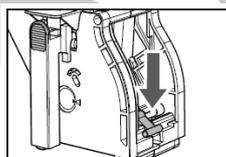
10、確定下圖箭頭指之零件是在正確的位置，檢查時可按壓《PREE》的位置。
