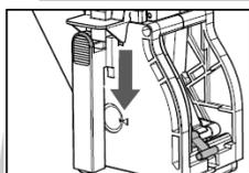
9、如下圖，將提起之拉桿往下壓至沖泡組底部即可。
