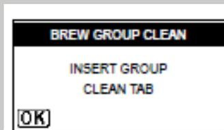
11、放一顆清潔錠於沖泡組內如下圖，之後將沖泡組放回機器，確定所有的設備零件均已歸位，關上服務門。
