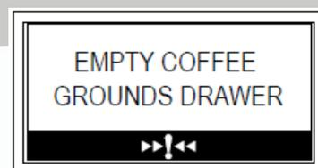
必須馬上執行如左下圖動作，將咖啡渣槽取出，清洗乾淨，此時 LED 顯示幕將出現下右圖訊息（將豆渣何歸位）
